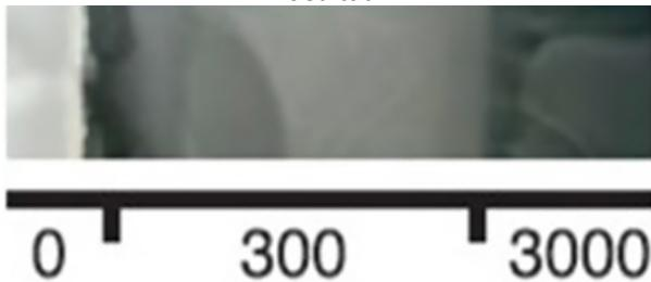
L'intensité lumineuse des photographies mesurée par Mesurim est fonction de la densité bactérienne : plus la bande est blanche plus elle contient de bactéries. On n'obtient jamais une intensité de 0%, on considère qu'une intensité <10% correspond à une absence d'intensité donc de développement bactérien.
